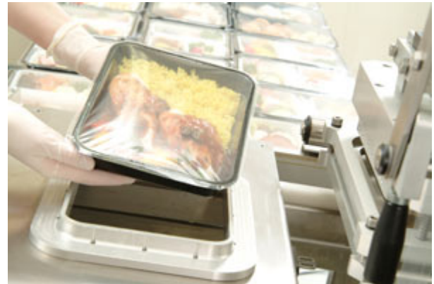
Рис. 2 Процесс упаковки продукции в индивидуальные барьерные лотки:
